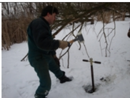
Zarážení jádrovnice na zamrzlé hladině
