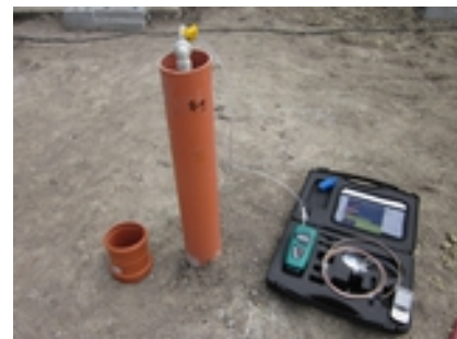
Monitoring půdního vzduchu na respirační sondě
